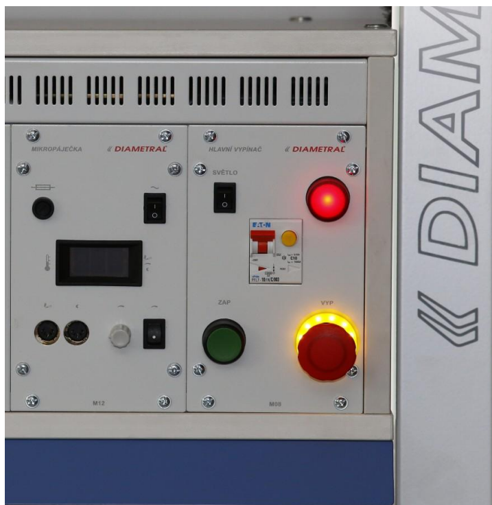
Modul Variolab+ s tlačítkem Total Stop a prosvětleným kroužkem LRY-01
